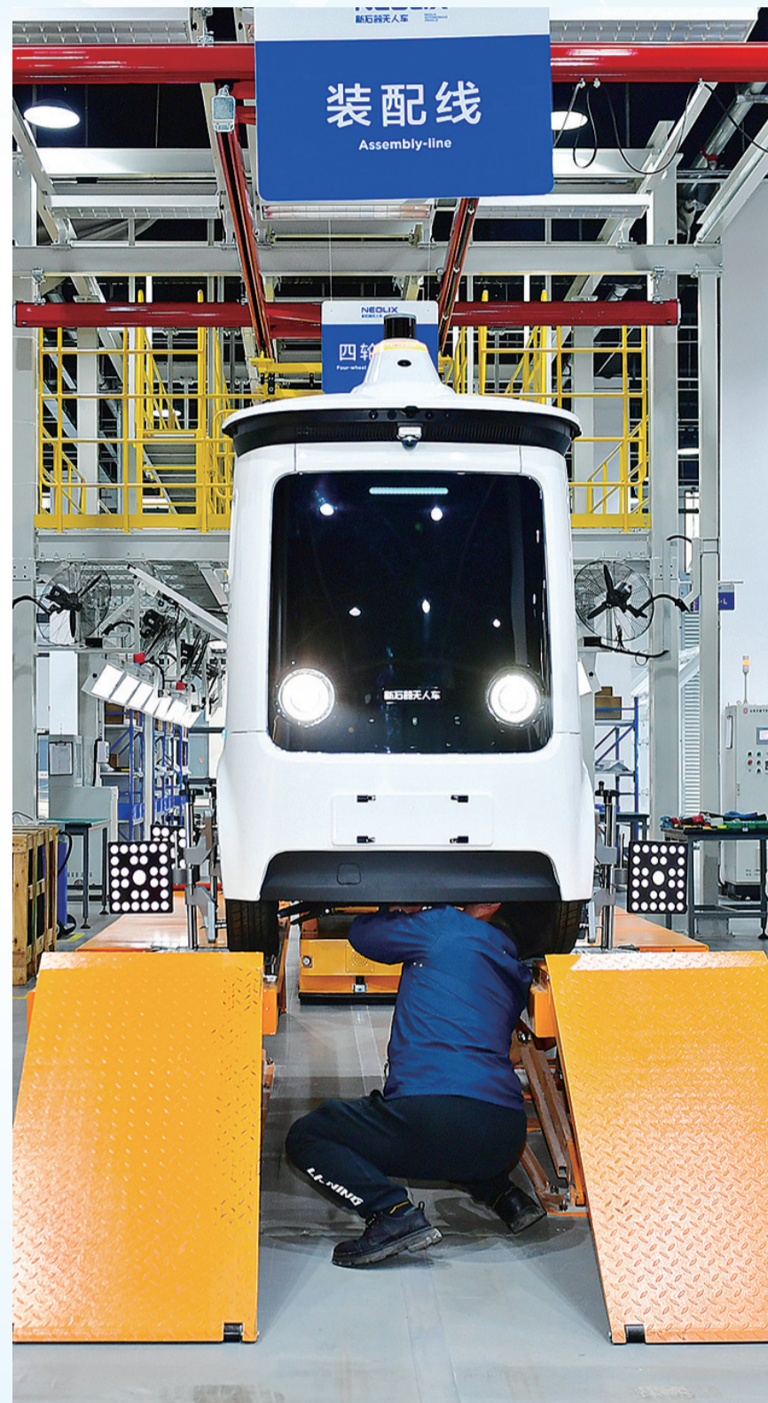
新石器无人车装配线，工人正在进行四轮定位。
