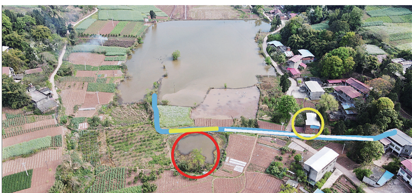
排水沟周边地形航拍。(蓝线为原本主排水沟位置,红圈为村民的鱼塘,黄圈处为邓福英家,白线处为后续淤堵位置,黄线处为被村民回填的排水沟位置)。
